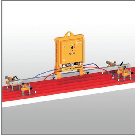
Montage von nahezu allen ISO - Paneelen und Trapezblechen. Bis zu 12 federnde und gelenkige Sauger tragen bis zu 400 KG ohne zusätzliche Haltegurte.
